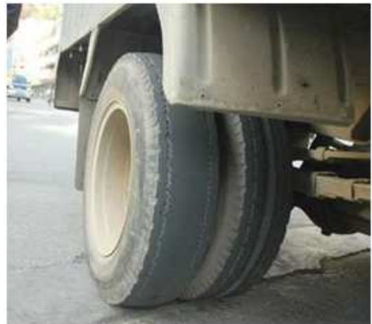
写真：中国のある物流会社のトラックのタイヤ溝が完全に磨り減ったまま走行しています。これでブレーキが効くのでしょうか？
